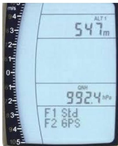
Die Anpassung des Höhenmessers erfolgt über die Änderung der Luftdruckreferenz.
