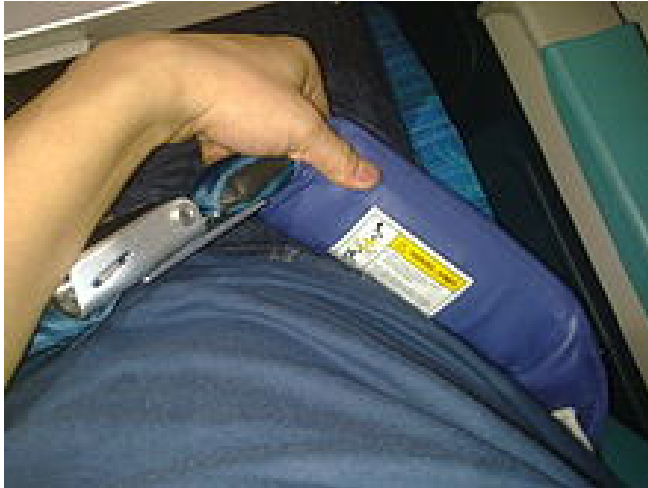
Airbag in einem AIRBUS A330 (Quelle: Airbus)
